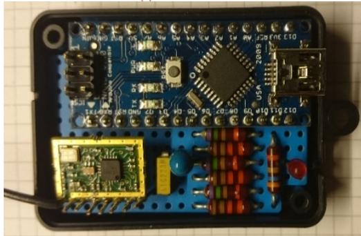
an Arduino nano 'Plagiat' hat die Verbindung Pin 25 nach Pin26 am FTDI232 Chip gefehlt. Durch Lötbrücke ergänzt.
